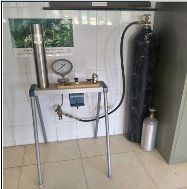
بمب فشار ( دستگاه اندازه گیری پتانسیل آب برگ (پرشر چمبر/پرشر بمب)
